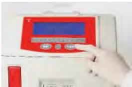
En 30 segundos se obtiene un primer resultado, mientras en los siguientes 30 segundos el analizador realizará una limpieza automática. Procesa ininterrumpidamente una muestra por minuto (equipo sin autosampler)
